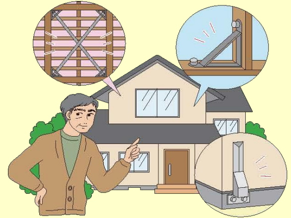
木造住宅耐震化の例
